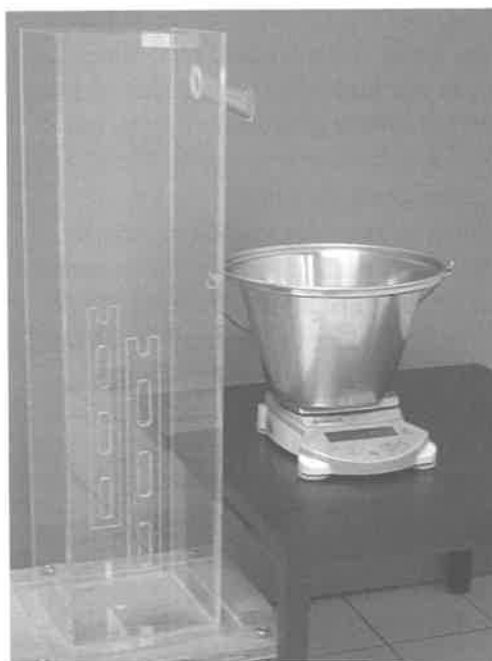
Figuur 14.1 Opstelling volumemeter in combinatie met een elektronische weegschaal.
